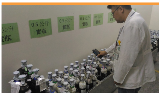
圖二、氧氣鋼瓶 RFID 掃描盤點
