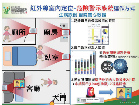
圖四、紅外線室內定位警示系統
